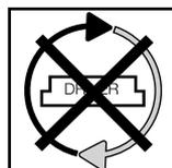
Dispositivo di alimentazione non sostituibile. Quando il dispositivo di alimentazione arriverà a fine vita dovrà essere sostituito l'intero apparecchio.
